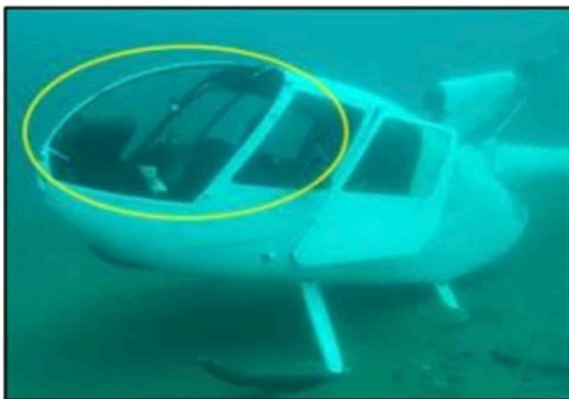
Fotografías N°3: Parabrisas izquierdo, desprendido.
