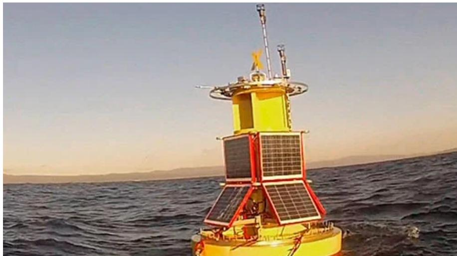
**Viento, radiación solar, salinidad, pH y clorofila en el mar** son algunos de los valores que mide la **Plataforma de Observación del Sistema Acoplado Océano Atmósfera (POSAR)**, proyecto liderado por el Centro de Ciencia del Clima y la Resiliencia (CR)2 que permitirá una descripción sin precedentes de las condiciones ambientales en la zona costera del centro y sur de Chile.
